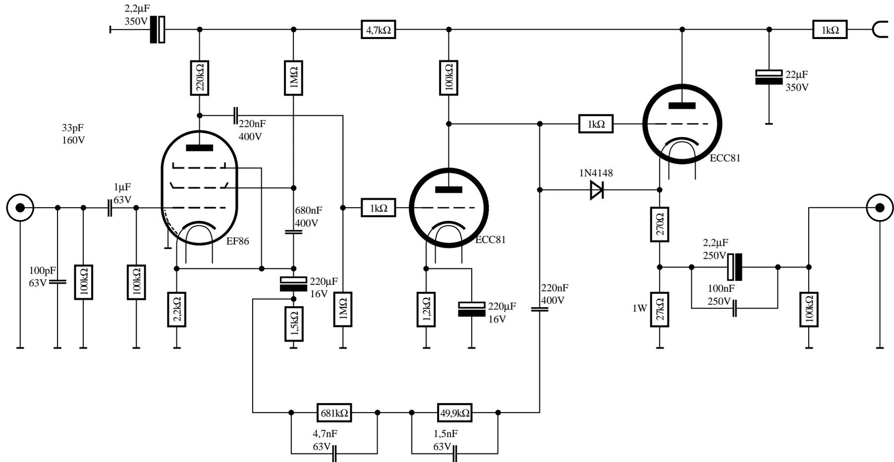
Widerstände und Kondensatoren 1% Toleranz.
